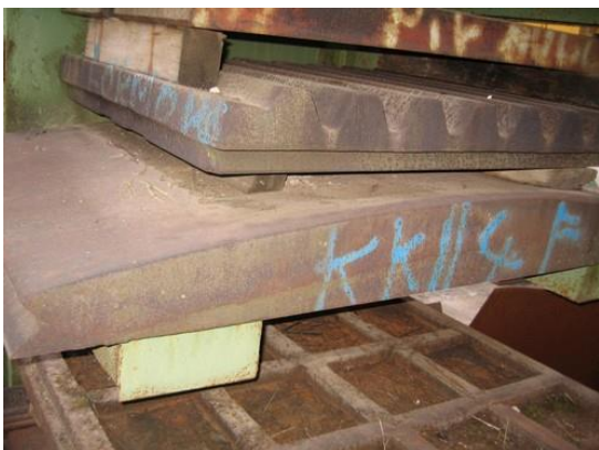
Feste Brechbacke für Backenbrecher Fabrikat Brown Lenox Typ. KK 114, glatt
