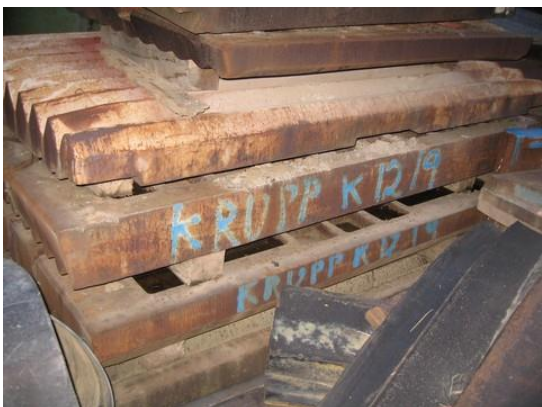
1 Satz Brechbacken für Backenbrecher KRUPP 12 K-9
