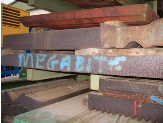
Brechbacke für Backenbrecher Fabrikat EXTEC Typ. Megabite
