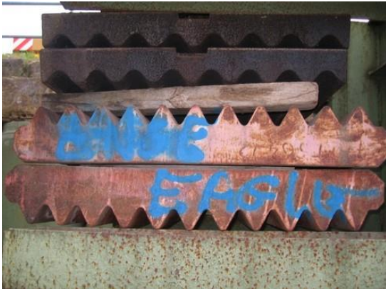
1 Satz Brechbacken für Backenbrecher Fabrikat Eagle
