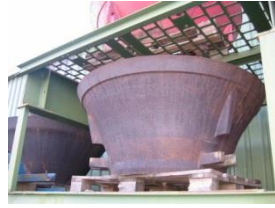
Brechwerkzeug (Außen und Innenmantel) Fabrikat Sandvik, Typ. H-36
