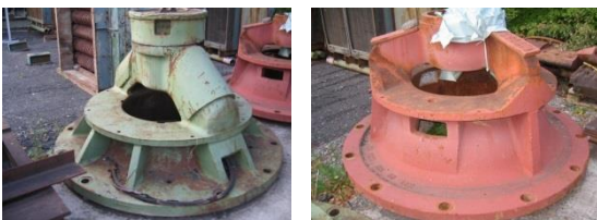
Svedala, H-51, Oberkopf-Lager („Wikingerschutze“), 2-armig und 3-armig Unterteil für Laufbüchse
