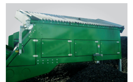
Breiter Aufgabebunker mit Kipprost
