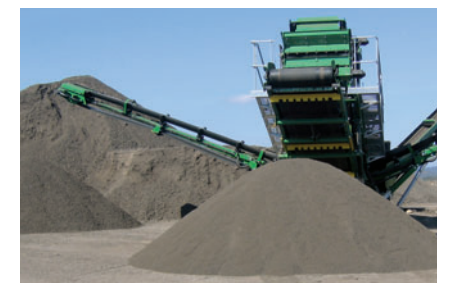
Abwurfbänder, sehr große Abwurfhöhe für maximale Haldenleistung
